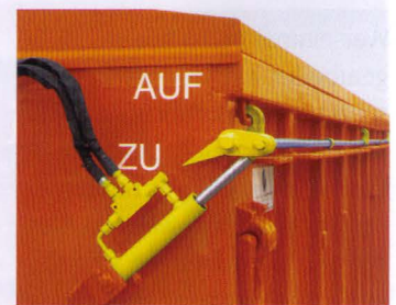
Durch Handbetrieb der Zweibegehydraulik wird keine externe Energiequelle benötigt.
