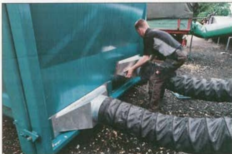
Die Trocknungsluftversorgung ist schnell angeschlossen. Die Lufttemperatur kann gradgenau eingestellt werden.
